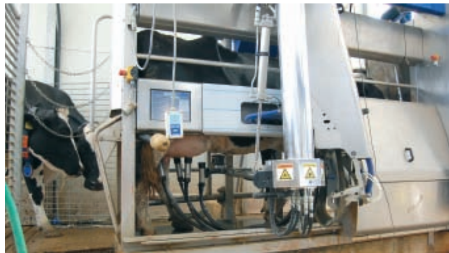
Sopra: uno dei quattro robot durante la mungitura.
